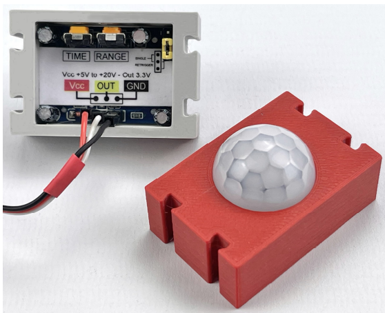
Abb. 10: Die Anschlusshinweise auf der Rückseite im Inneren des Gehäuses
