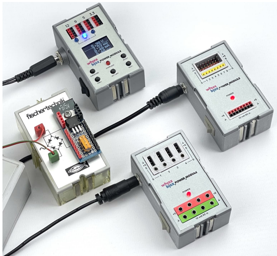
Abb. 2: Verschiedene DIY-5-Volt-Stromversorgungen für weitere Sensor-Experimente
