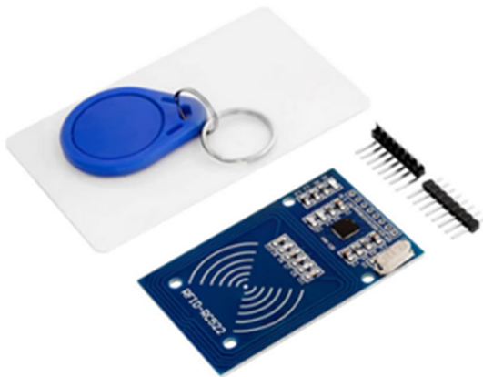
Abb. 3: NFC-Leseinheit RFID-RC522, ca. 7 € (wird meist mit 2 Tags verkauft).
