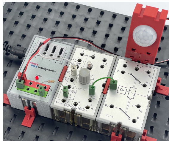
Abb. 13: Erkennung des 3,3-Volt-Ausgangs durch den Grundbaustein mit 10 k \Omega -Widerstand zwischen Bus 6 und Masse
