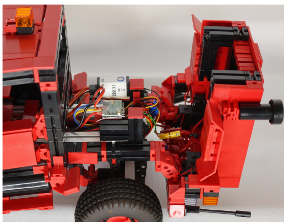
Abb. 9: Unter der Motorhaube befinden sich der Empfänger und der Fahrregler für die Antriebsmotoren
