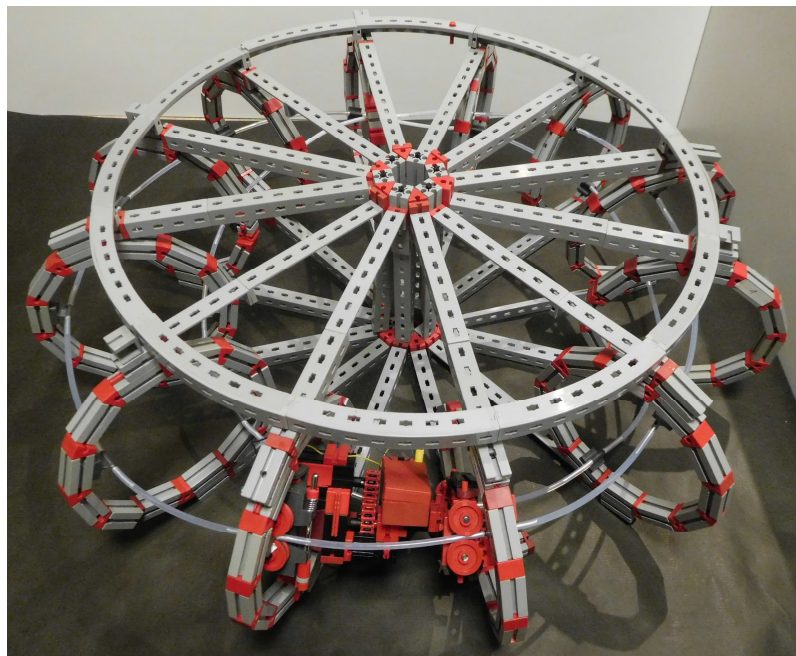
Abb. 10: Möbius-Bahn mit Schlauchschiene – Der Schlauch ist mit gegenüberliegenden Schlauchhaltern an den Halterungen befestigt. Von Ring zu Ring sind die Halterungen um 15^\circ verdreht angebracht, sodass der Schlauch sich nach zwei Umrundungen wieder schließt.
