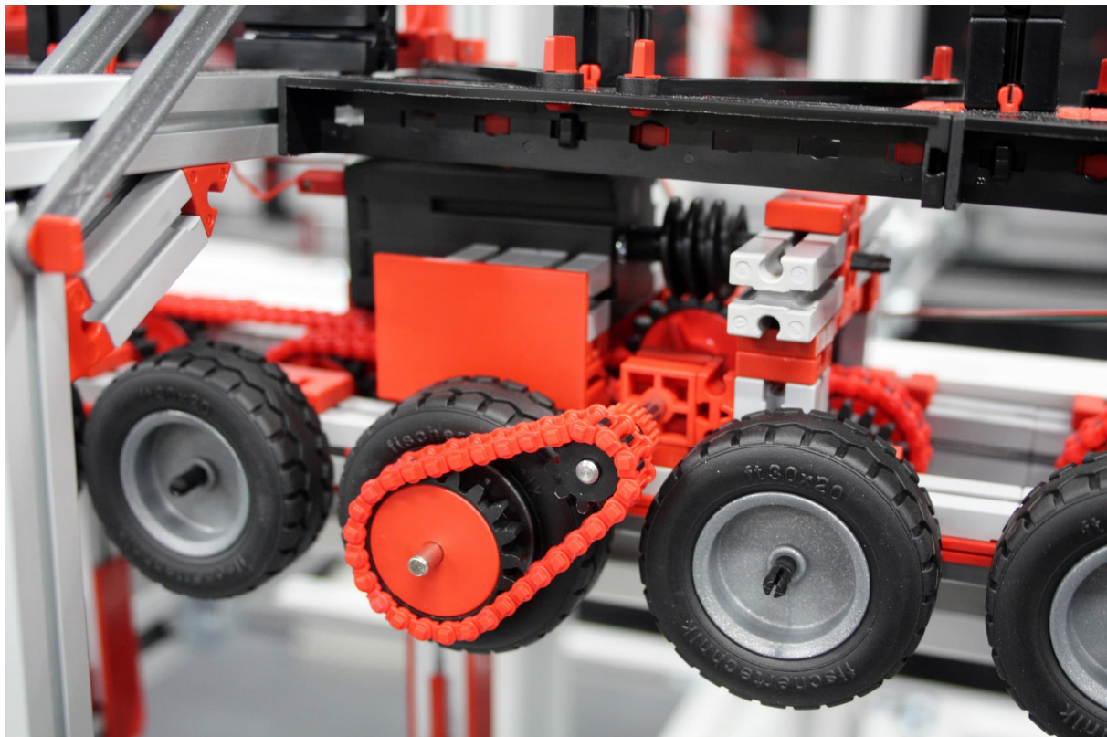
Abb. 6: Der Antrieb der neuen Version ist als eigenständiges Modul ausgeführt und kann leicht gewartet werden. Je nach Bedarf kann er vorne oder hinten angebracht werden und stabilisiert dabei gleichzeitig den Reifenförderer.
