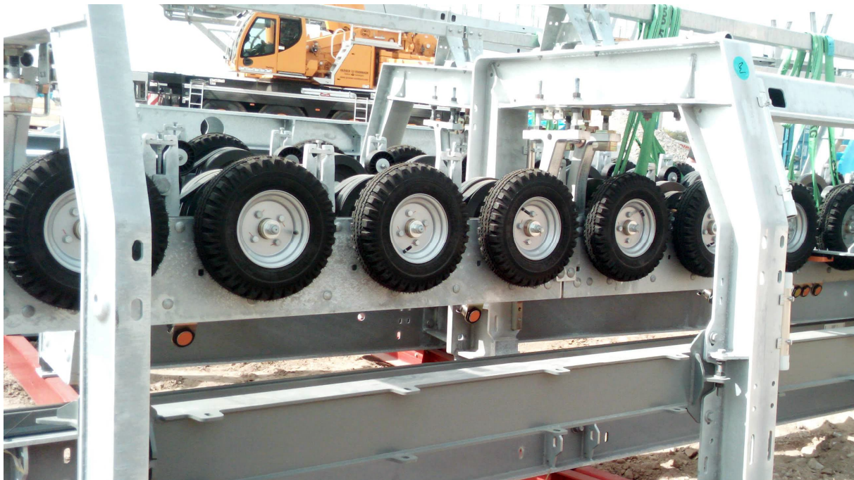
Abb. 1: Die Reifenförderer der originalen BUGA23-Seilbahn im Spinelli-Gelände Mannheim vor dem Einbau. Die Stahlkonstruktion, welche diese wie ein Bogen überspannt, nennen wir „C-Stücke“; sie wurden mehrfach in unseren Beiträgen erwähnt.
