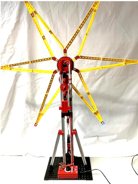
Abb. 8: Der Stern von hinten. Das Gerüst ist aus Alu Maker Beams gebaut. Damit die Gardine nicht ins Getriebe kommt, wurde noch ein Schutz aus Statikteilen angebaut.
