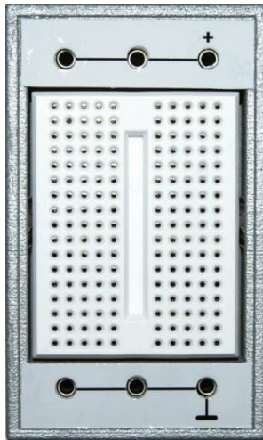
Abb. 287: Nachbau 2: Ein Breadboard als Alternative zum Experimentierfeld für das 45×75-Gehäuse
