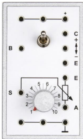
Abb. 250: Nachbau 2: Frontplatte des VB für das 45×75-Gehäuse
