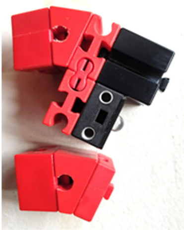
Abb. 30: Montage der Rutsche mit dem Leuchtstein für den Geldeinwurf (1)
