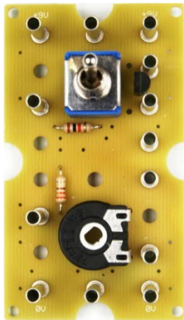
Abb. 251: Nachbau 2: Platine des VB für das 45×75-Gehäuse
