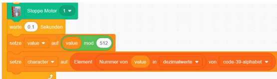
Abb. 7: Umwandlung des Binärwerts in das dekodierte alphanumerische Zeichen
