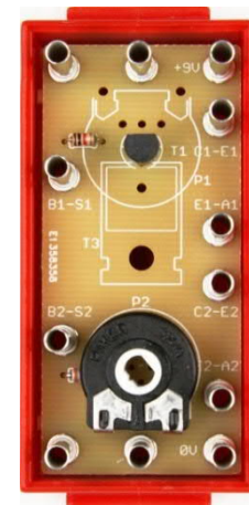
Abb. 266: Nachbau 4: Platine des TP für das 30×60-Gehäuse
