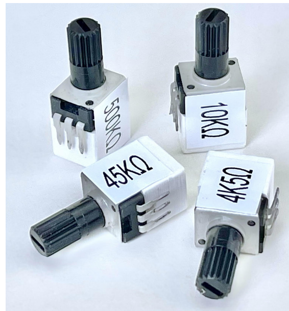
Abb. 9: Modular austauschbare Potentiometer
