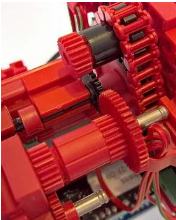
Abb. 4: Uhrengetriebe einer leicht stellbaren Analoguhr mit Schrittmotor [4]
