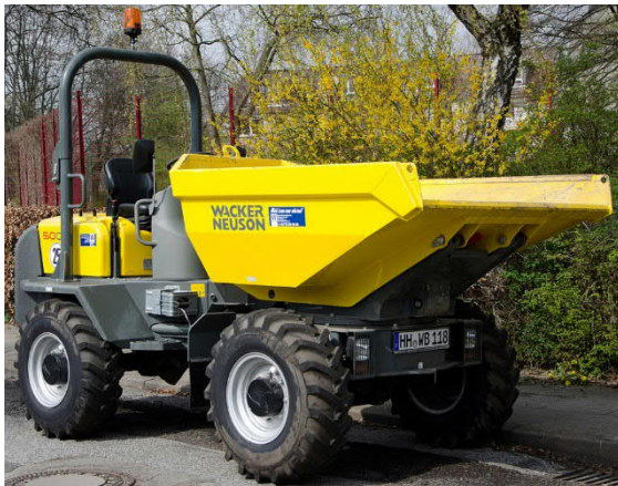
Abb. 1: Dumper mit Allradantrieb (Quelle: Vorderkipper. Gemeinfreies Bild , Wikipedia 2012)
