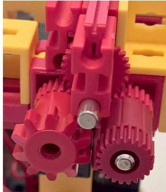
Abb. 2: Zwei Achsen in gleicher Drehrichtung antreiben
